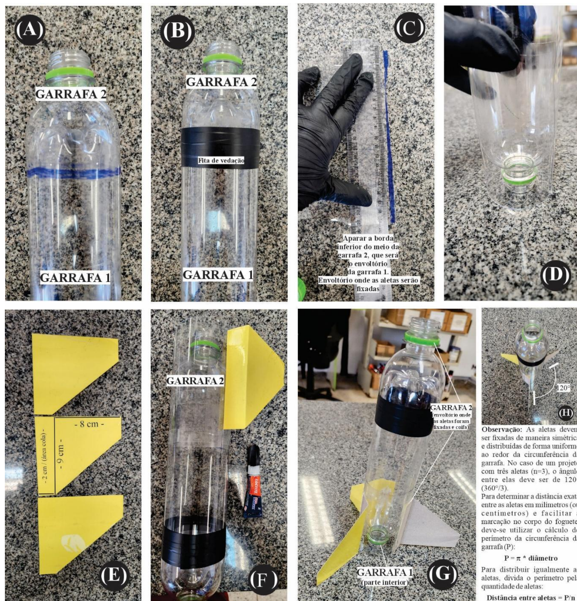
Figura 12. Apresenta a montagem do envoltório para fixação das aletas no foguete nível 3. Em (A), a parte central da Garrafa 2 é posicionada sobre a Garrafa 1; em (B), aplica-se fita adesiva resistente para fixar a união entre as peças; em (C), realiza-se o acabamento da borda inferior do envoltório da Garrafa 2; e, em (D), observa-se o cilindro ajustado no corpo do foguete. Em (E), são mostrados os moldes das aletas, com aproximadamente 8 cm de comprimento, 9 cm de altura e aba de 2 cm para colagem; em (F), as aletas são fixadas ao envoltório; em (G), apresenta-se o foguete com as aletas instaladas; e, em (H), destaca-se a necessidade de distribuir as aletas de forma uniforme ao redor da circunferência da garrafa, mantendo ângulos de 120° entre elas quando forem utilizadas três aletas.
